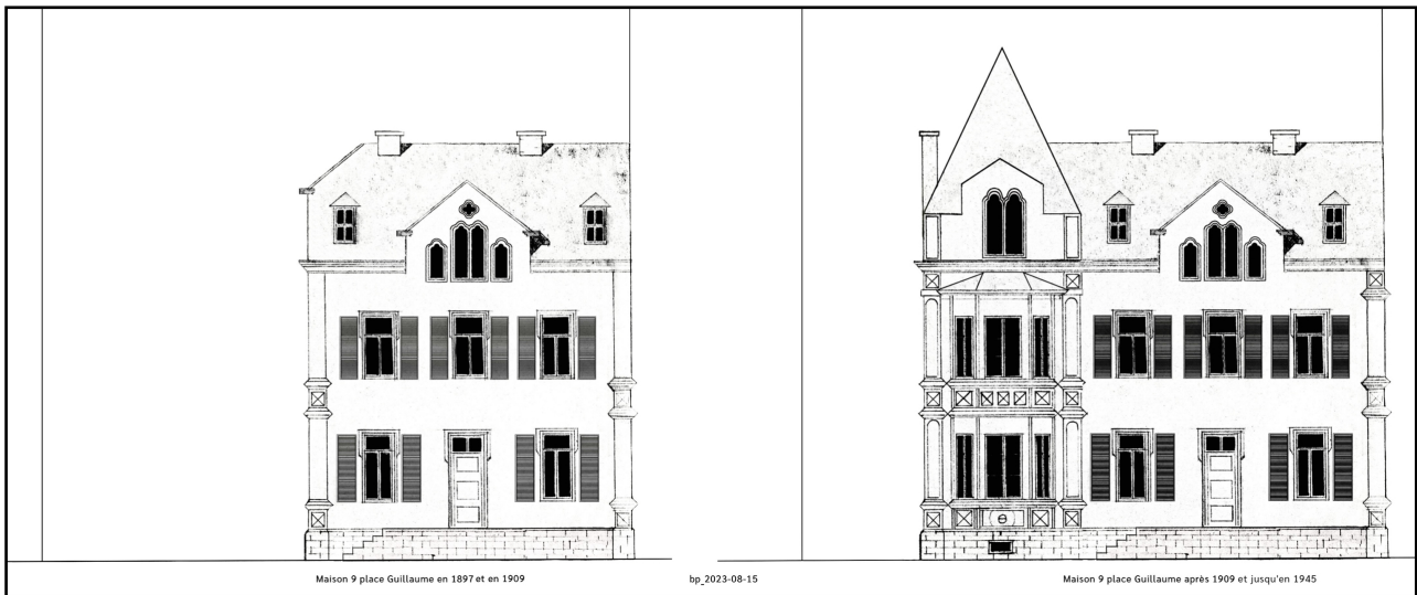
Maison PEMMERS, 9 place Guillaume à Diekirch, au fil du temps: À gauche, volume original, figurant sur des documents photographiques de 1897 et 1909; à droite, adjonction d'un volume latéral vers l'orient, donc postérieur à 1909. Reconstruction de la façade nord d'après des photographies anciennes publiées par Nico BECKERICH, Diekirch au fil du temps, 2012, ISBN 978-99959-676-5-9 et sur base des plans dressés en 1958 par l'architecte Jean Pierre THILL (*1916, +1981) de Diekirch. [Dessin: bp_2023; dépositaire du plan origin
